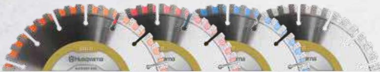
**SPEED BRÜCKE** Die Elite-Cut Trennscheiben sind mit einer speziell entwickelten Brücke zwischen den Segmenten ausgestattet. Dieses Design ermöglicht eine weitere Verbesserung der Schneidgeschwindigkeit und Schnittglätte aufgrund reduzierter seitlicher Reibung, verbesserter Kühlung und effizienterem Staub-Abtransport. Die Farbe der Brücke gibt an, für welches Material die Trennscheibe optimiert ist.
