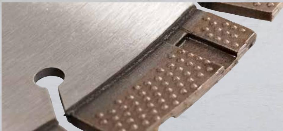
**NEU EXO-GRIT** Das neue Elite-Cut S35, S45 und S65 Trennscheiben ist mit dem EXO-GRIT Diamantsegment ausgestattet. Dieses neue Design verringert die seitliche Reibung, verbessert die Schnittgeschwindigkeit und Glätte sowie eine bessere Kühlung und verbesserte Staubbeseitigung. Geeignet für Fugenschneider mit niedriger und mittlerer Leistung.
