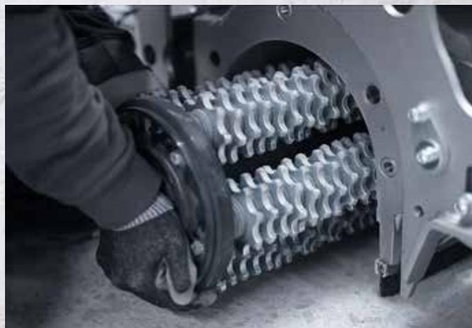
**SEITLICHE TROMMELBELADUNG** Husqvarna Bodenfräsen sind speziell so konzipiert, dass die Trommel ganz einfach seitlich abgenommen werden kann, ohne dass die Maschine bewegt werden muss.
