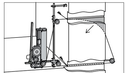
Vertikale Schnitte mit CS 10 und externen Umlenkrollen.
