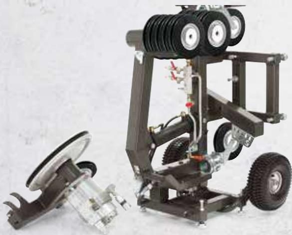
**MODULAR** Durch die Modulbauweise ist die CS 2512 leicht zu handhaben und aufzustellen. Sie kann vertikal und horizontal verwendet werden. Der Motor ist abnehmbar, um den Transport zu erleichtern.
