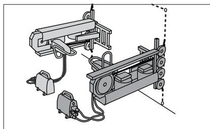
Die CS 10 kann zum Rechts- oder Linkssägen montiert werden. Dies ermöglicht hervorragende Flexibilität bei der Installation und der Wahl der Sägerichtung.
