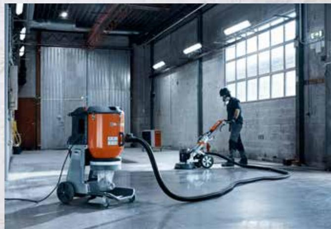
**RANDSCHLEIFEN** Sowohl mit dem HTC 270 EG als auch dem PG 280 können Sie problemlos bis an die Ränder schleifen. Das HTC 270 EG wurde speziell zum Randschleifen entwickelt und bietet eine Vielzahl von Einstellungen für jede Situation. Der längliche Bau der Maschine ermöglicht den Zugang zu schwer zugänglichen Stellen, etwa unter Treppen, Heizkörpern oder anderen feststehenden Hindernissen.
