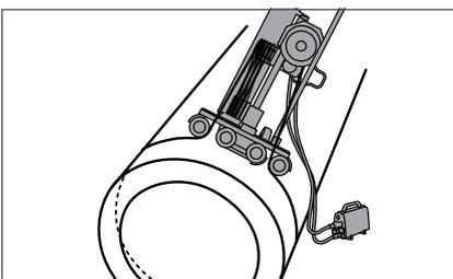
Durch die flexible Konstruktion von CS 10 kann das System zum Beispiel an Rohrleitungen montiert werden.
