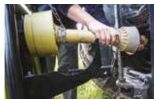
Klappbare Gelenkwellenablage zum Schutz vor Verschmutzung und Beschädigung
