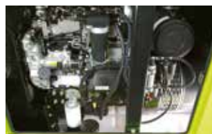
Kompakter Aufbau mit integriertem Kunststofftank
