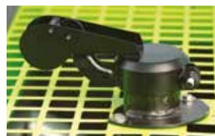
Silencieux d'échappement avec clapet anti-pluie
