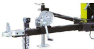
Treuil à manivelle pour soulever et incliner
