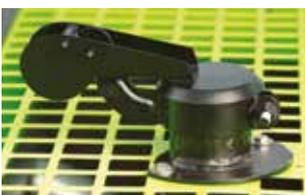
Silencieux d'échappement avec clapet anti-pluie
