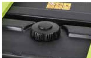
Grand réservoir de carburant intégré pour une autonomie accrue (24L)
