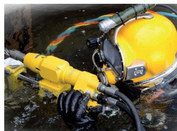
Les outils hydrauliques portatifs sont compacts et polyvalents. Il existe des nombreux appareils différents pour toutes les utilisations possibles et imaginables – marteaux perforateurs, carotteuses, tronçonneuses, enfonceurs de pieux, extracteurs de pieux, pompes, meuleuses d'angle, perceuses d'angle, écarteurs de palettes, etc.
