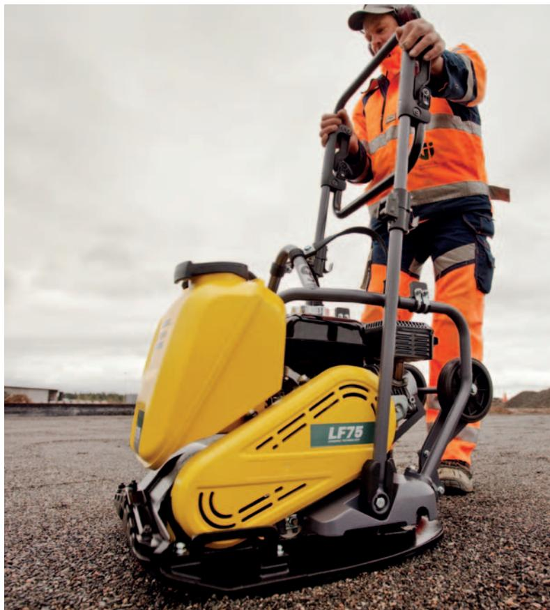
Le point d'attache centré de la poignée rend possible le levage en position verticale, ce qui facilite le travail à proximité des obstacles.
