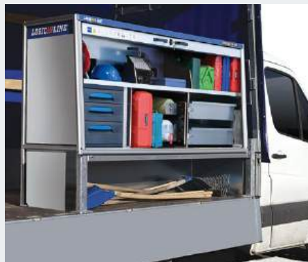
zusätzlicher Stauraum durch Aufständigung auf Bordwandhöhe*; optionale Abdeckbleche zur Abgrenzung
