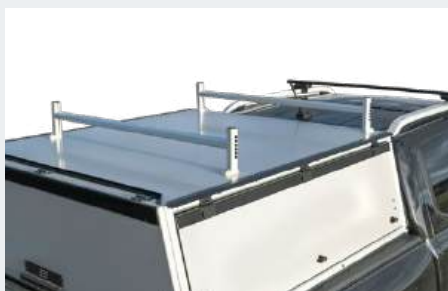
PS-200 mit Auflagebügel* und Dachträger* zum einfachen Transportieren von Langgut
