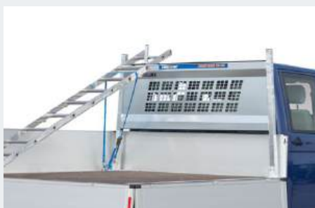
FR-100 speziell für VW Transporter; integrierter Heckscheibenschutz hemmt das Eindringen von Ladung in die Fahrerkabine
