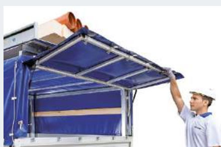
Heckklappe* für komfortables Öffnen und Schließen der Plane
