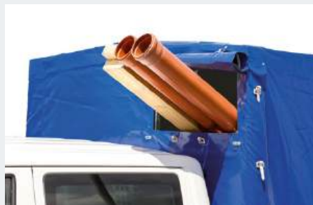
schräger Transport von Langgut mit Ladeluke*
