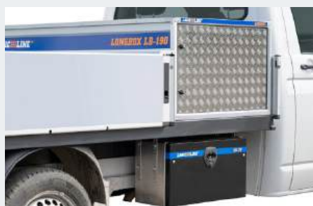
LongBox im geschlossenen Zustand; integriert in die Bordwand*
