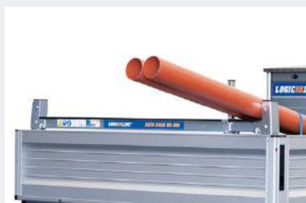
HR-350 zum schrägen Transport von Langgut; Querträger werkzeuglos abnehmbar; Bordwand als Auflage für Lasten nicht geeignet!
