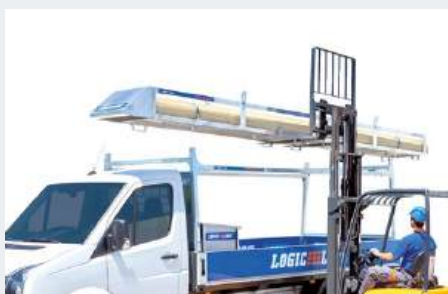
LongRack kann mit Stapler oder Kran auf das PowerRack geladen bzw. auf das Dach gehoben werden
