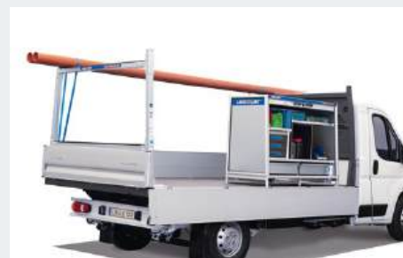
HR-200 kombiniert mit werkseitigem Fahrerhausschutz und Toolbox; Hinweis: Diese Variante ohne FrontRack Adapter ist nicht bei allen Fahrzeugen möglich, wir beraten Sie gerne.
