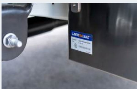
die LogicLine UnterflurBoxen sind vom KBA als Unterfahrerschutz genehmigt
