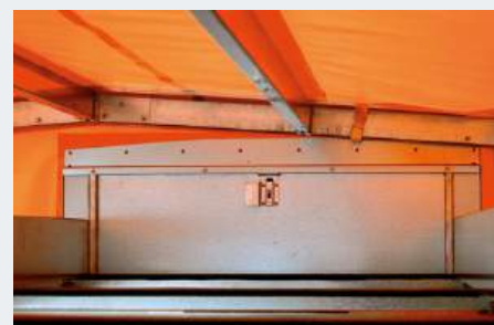
Ladeklappe* für komfortables Öffnen und Schließen der Beladeöffnung von innen
