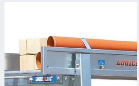
geprüfte Zurrpunkte im Langgutträger
