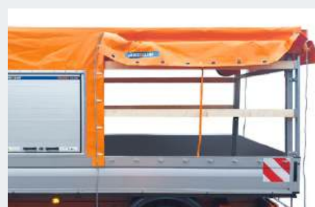
seitlicher und / oder heckseitiger Planenlift* zum schnellen und unkomplizierten Öffnen und Zugreifen
