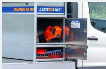
versperrbarer Stauraum* für langstieliges Werkzeug; Zugriff und Beladung von beiden Fahrzeugseiten
