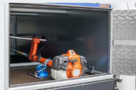
Querverstrebung in der Mitte schützt Ladung vor Verrutschen, schwere Einzelgüter ab 20 kg sind kraftschlüssig zu sichern, z.B. mit Zurrset für Gefahrgut*
