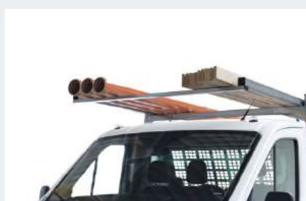
PowerRack mit Frontausleger* für den horizontalen Transport von schwerem Langgut
