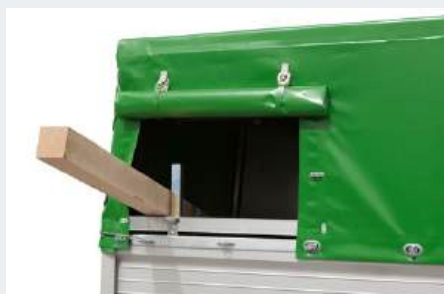
heckseitige Ladeluke* für schrägen Langguttransport; inklusive abnehmbarer Lastenauflage
