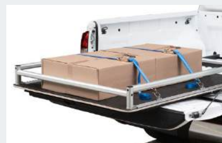
Formschluss durch umlaufende Reling*
