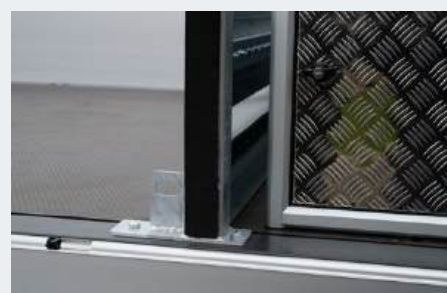
bei direkter Montage des Ladeflächenteilers an eine Transportbox entsteht aufgrund der Fußkonsole ein Abstand von 35 mm
