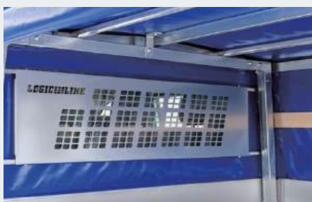
Heckscheibenschutz* hemmt das Eindringen von Ladung in die Fahrerkabine
