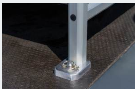
Standfüße* (Höhe = 100 mm) und Schnellmontagesystem* zur einfachen, werkzeuglosen Montage und Demontage der Box auf der Pritsche
