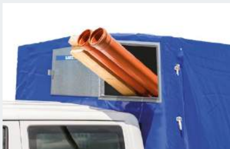
Ladeklappe* für komfortables Öffnen und Schließen der Beladeöffnung von innen
