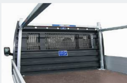
PowerRack auch bei Ford Transit möglich: Montage hinter / zwischen dem werkseitigen Fahrerhausschutz
