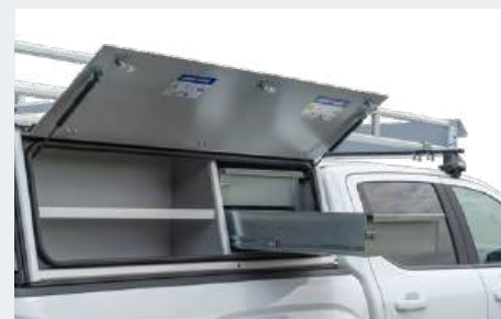
modular ausstattbar: Auszugslade* für noch besseren Zugriff und Überblick, Seitenbox* mit Zwischenboden*
