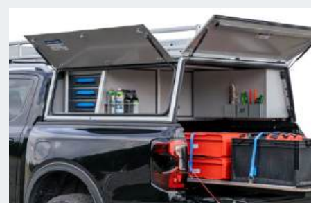
PS-200 mit Seitenbox* beifahrerseitig, Ladencontainer*, Dosenhalter*, Werkzeughalter*, Langgutträger*; kombiniert mit PickUp Schwerlastauszug (Details S. 43)
