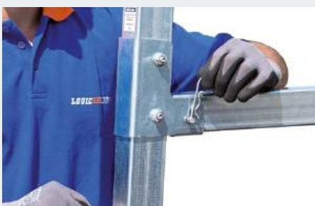
werkzeuglos abnehmbare Lastenauflage* zum schrägen Transport von Langgut am Heck des Fahrzeugs
