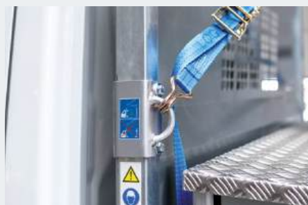
frei positionierbare Zurrkonsole* zur kraftschlüssigen Ladungssicherung
