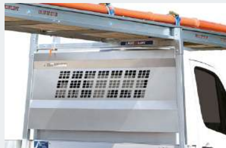
Heckscheibenschutz* hemmt das Eindringen von Ladung in die Fahrerkabine
