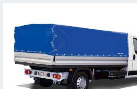
Planen / Spriegelaufbau ohne Boxenintegration (Normaldach)
