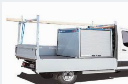
HR-200 kombiniert mit FrontRack Adapter*** auf werkseitigem Fahrerhausschutz und RoadBox
