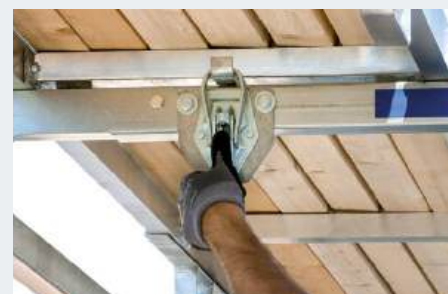
Schnellmontagesystem* für die rasche Befestigung des LongRacks auf dem PowerRack
