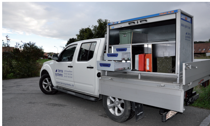
Pick-up mit Büro und fahrender Werkstatt in einem (ToolBox).
