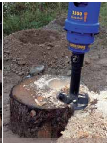
Baumstumpf-Fräsböhrer zur raschen und sauberen Entfernung von Stöcken.
