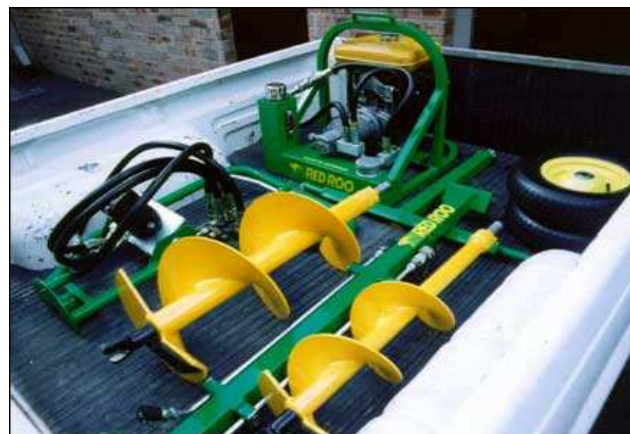
Bohrgerät zerlegt für den Transport
